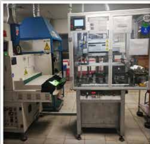
網印機台改裝自動化操作
