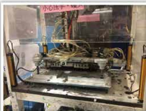
剪刀機改造前工作區域沒有防護罩
