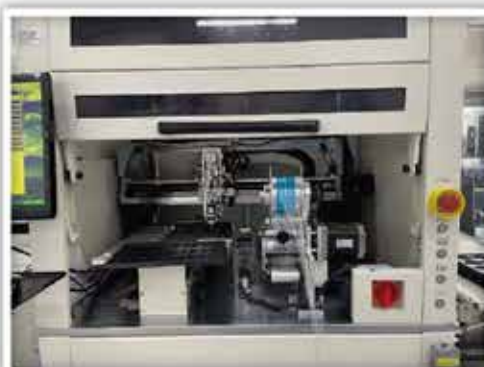
貼片機增射光電感應裝置，防止誤動做，減少工傷
